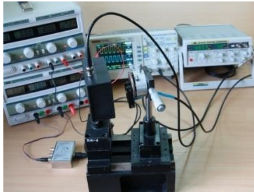
Rys. 1. Fotografia stanowiska przeznaczonego do pomiaru charakterystyk I - V fotodiod lawinowych
