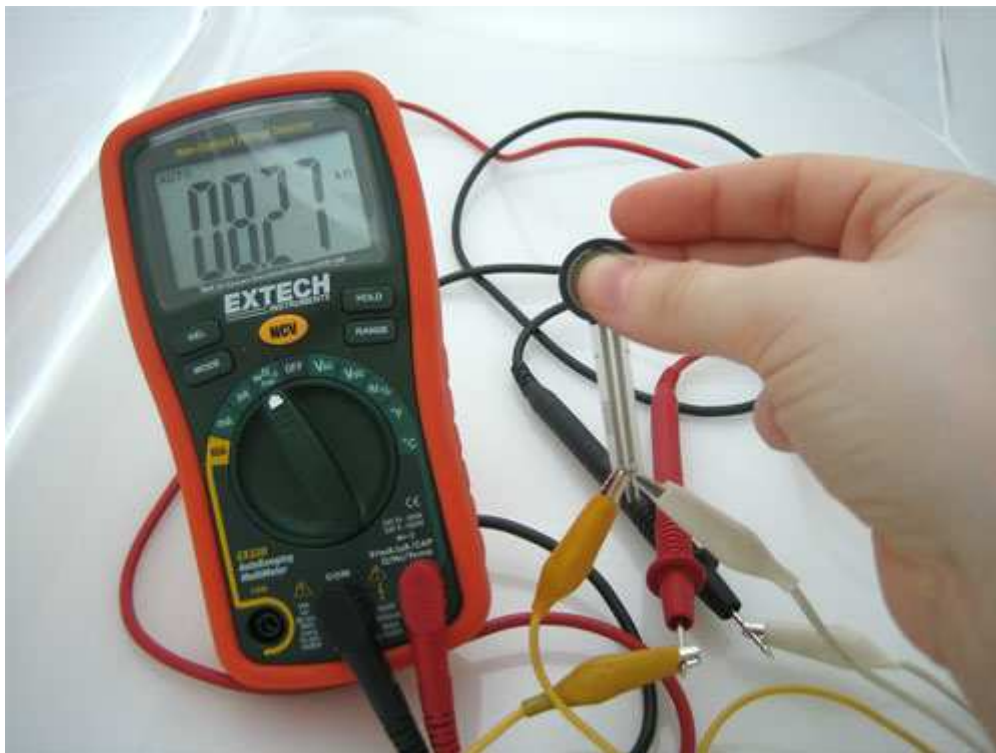
Rys. 6. Fotografia czujnika nacisku podłączonego do miernika rezystancji
